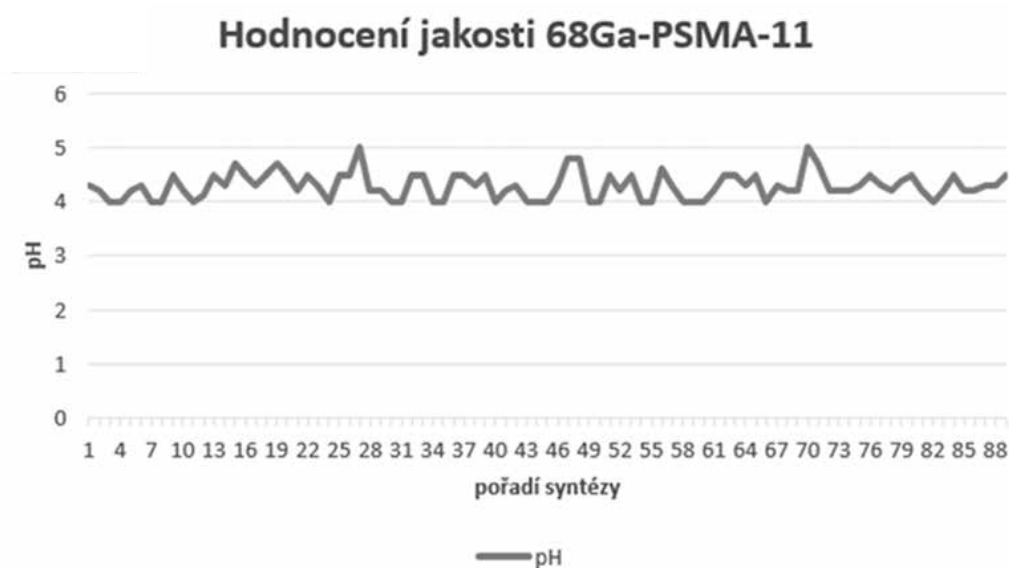
Obr. 4. Hodnota pH radiofarmaka ^{68}\text{Ga} -PSMA-11 ÚL MOÚ Brno
