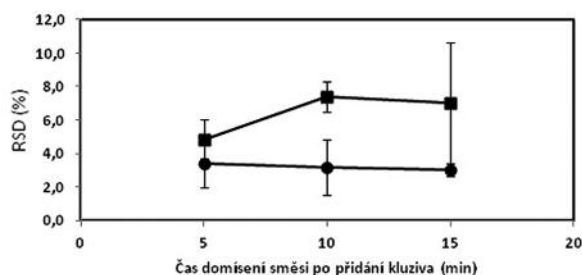
Obr. 1. Vliv času domísení na obsahovou stejnoměrnost tabletové směsi o složení 1 (■) a 2 (●) – dle tabulky 1; chybové úsečky znázorňují maximální a minimální hodnotu RSD v rámci připravených šarží
