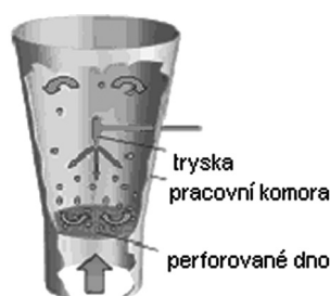
Obr. 3. Zařízení s vrchním nástřikem (přepřacováno dle 15) )
