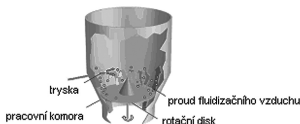
Obr. 5. Zařízení s tangenciálním nástřikem (přepřacováno dle 15) )
